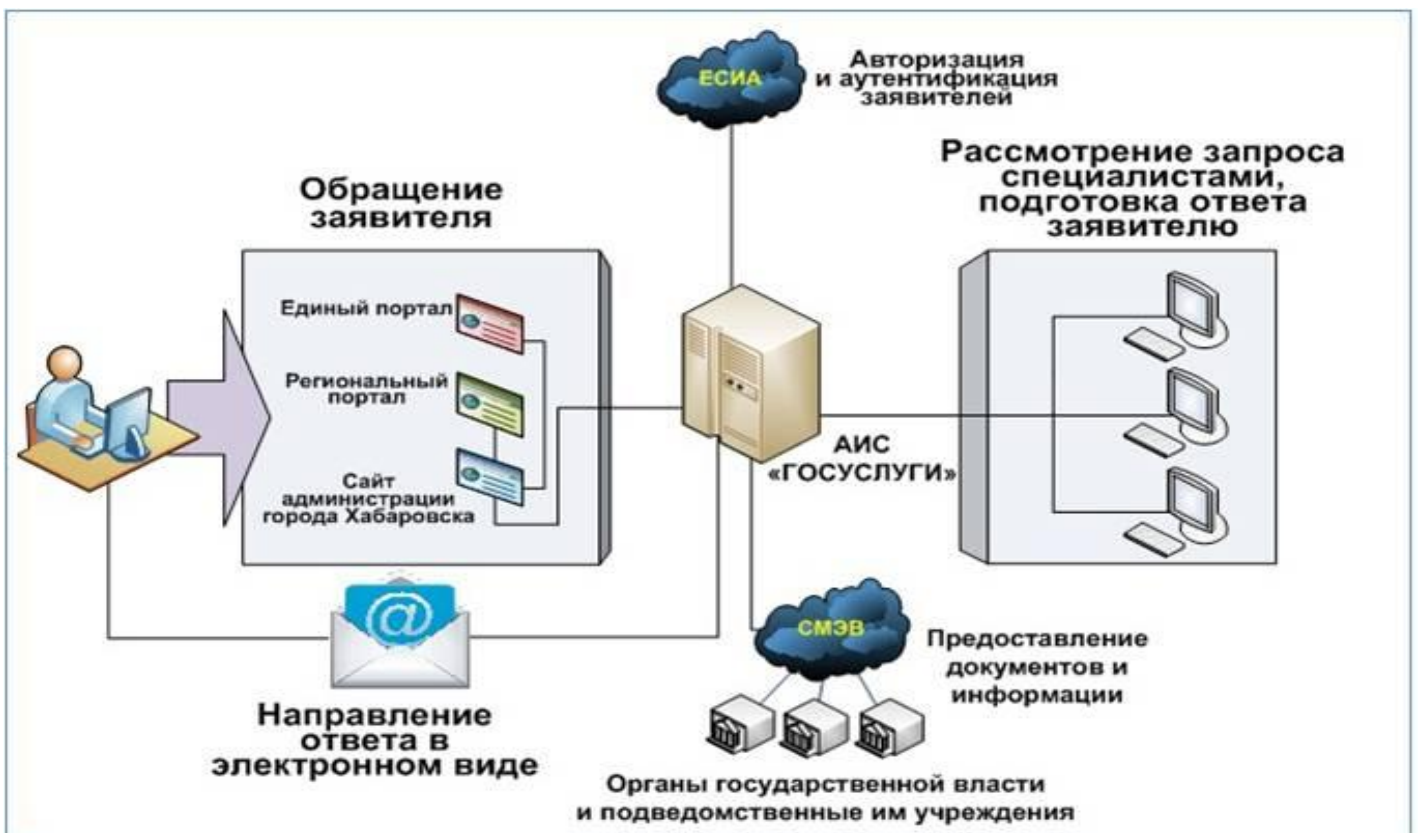
Рис. 4. Схема функционирования АИС «ГОСУСЛУГИ» при предоставлении муниципальных услуг
